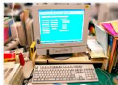
▲ハードロックキーが挿さらないと校務サーバにアクセスすることができない。もちろん、自分の PC 専用
